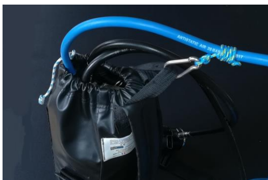
Fixation du mousqueton sur la poignée du sac, pour que le tuyau ne tire pas sur la valve, s'il venait à être en tension lors de la plongée
