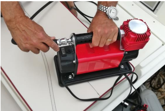
Vissage du raccord d'alimentation de la bouteille sur l'embout coudé de valve
