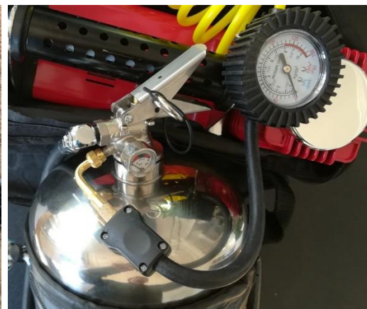
Gonflage par une simple valve de pneu sur la bouteille
